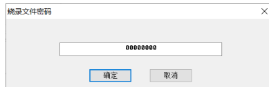
图 4.5-2 “烧录文件密码”设置对话框，设置密码后，再次加载此烧录文件切换至研发模式时需要此密码
